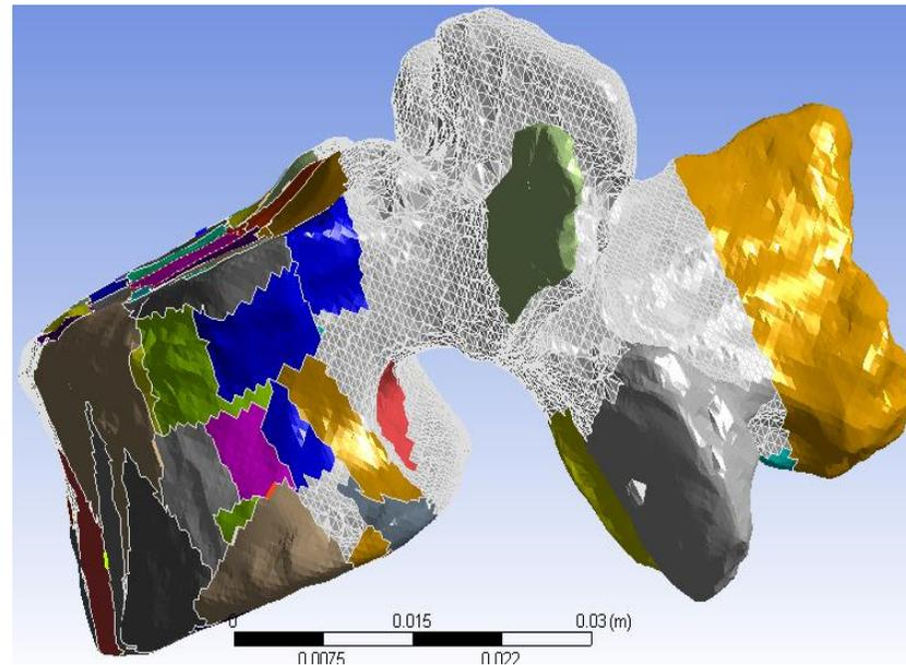
**Figura 5 Seccionado de caras con mayor superficie.**
